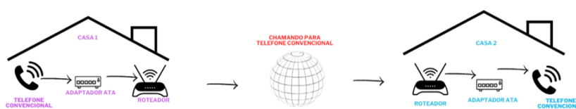
Figura 1. Funcionamento de uma ligação VoIP
