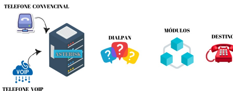
Figura 2. Funcionamento do Asterisk
