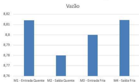
Figura 5 – Vazão Teste 2 (sem vazamento nas linhas de transmissão)
