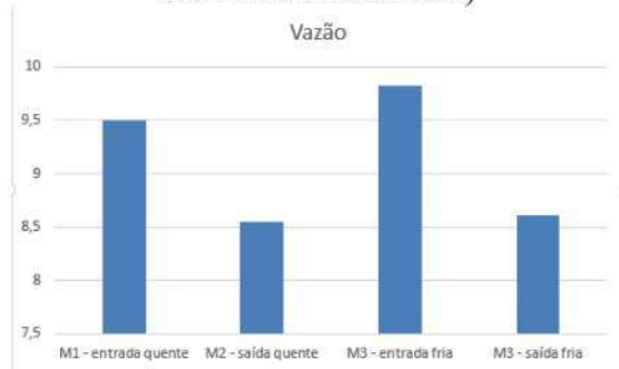
Figura 3 – Vazão Teste 1 (com vazamento nas linhas de transmissão)
