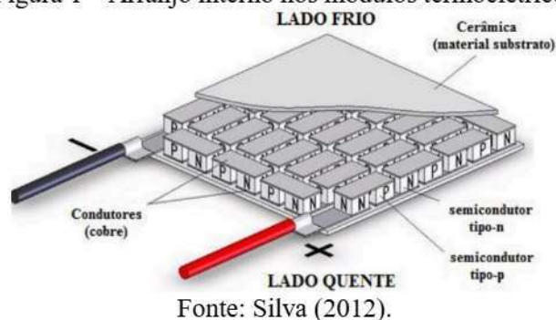
Figura 1 – Arranjo interno nos módulos termoeletricos
