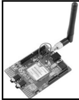
Figura 4. Módulo *GSM/GPRS*.
