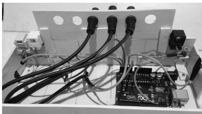
**Figura 6 - Parte interior do Módulo – Placa Arduino, Barramento e Conexões.**
