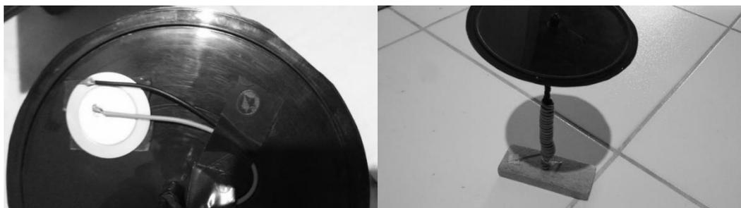
**Figura 9 - (Sensor Piezo fixado e visão superior do prato)**
