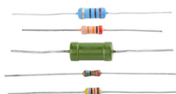
Figura 13. Exemplos de resistores comuns.
